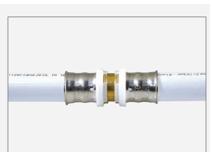
Zwischen 1 und 4.5 bar geprüfter verpresster Fitting - dicht
