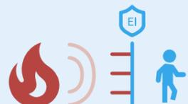
**Leistungskriterium EI «Raumabschluss und Wärmedämmung»:** Der Durchgang von Feuer und Wärme wird verhindert. Der Temperaturanstieg auf der feuerabgewandten Seite des Elementes darf 180°C bzw. durchschnittlich 140°C nicht überschreiten.
