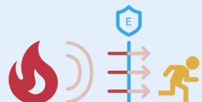
**Leistungskriterium E «Raumabschluss»:** Der Durchgang von Feuer wird verhindert, jedoch nicht der Durchgang der Wärme.
