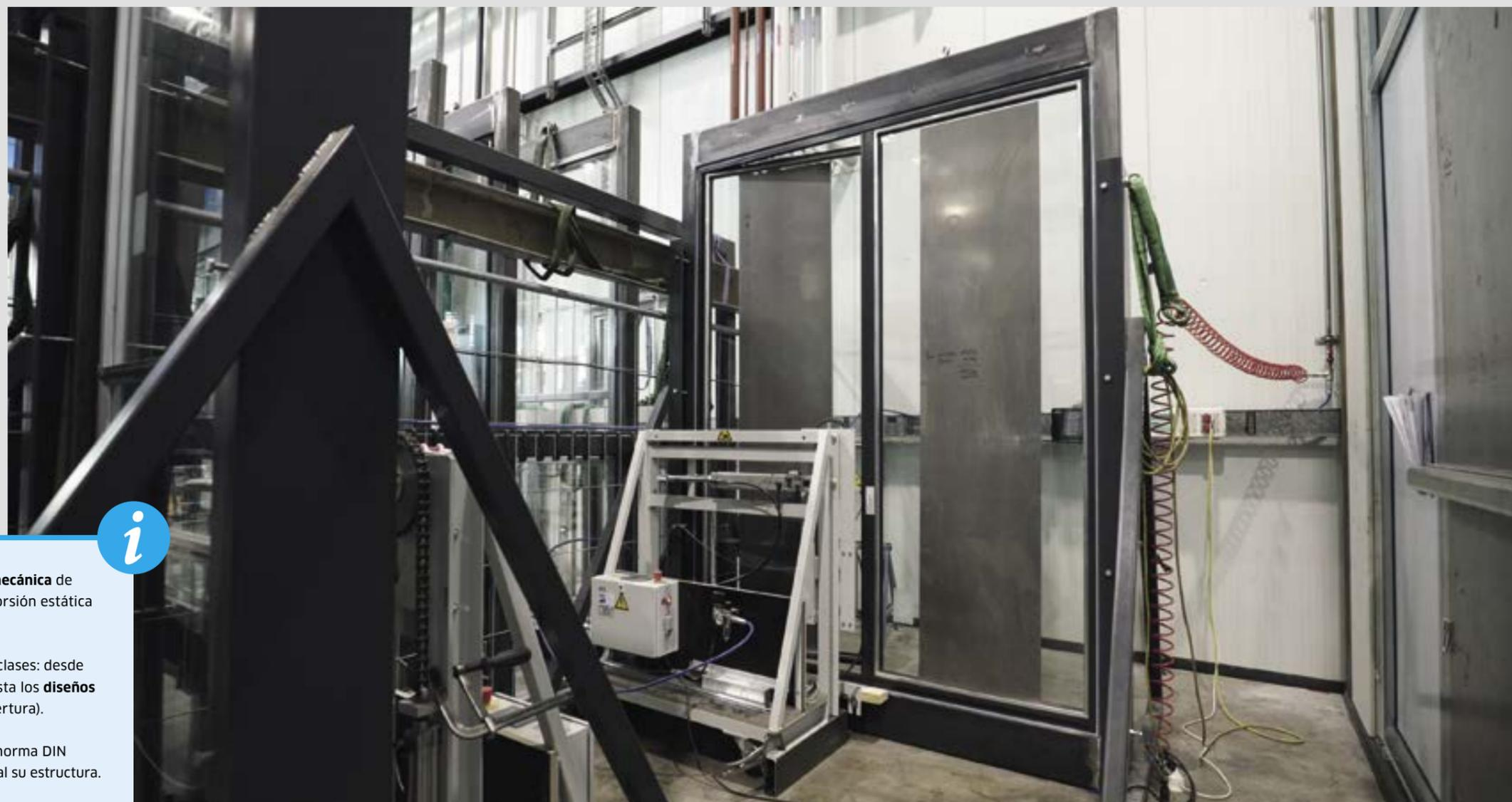
La norma DIN EN 1192 clasifica los **requisitos de resistencia mecánica** de las puertas de acuerdo con su resistencia a la carga vertical, torsión estática e impacto al cuerpo blando, pesado y duro.
