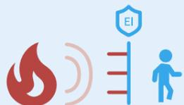
**Criterio de rendimiento EI «Integridad y aislamiento térmico»:** se detiene el paso de las llamas y del calor. El aumento de temperatura en el lado del elemento opuesto al fuego no debe superar los 180 °C o los 140 °C de media.
