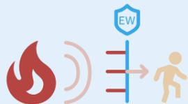
**Criterio de rendimiento EW «Integridad y reducción de radiación»:** se detiene el paso de las llamas. Además, la transmisión de calor está limitada a 15 kW/m<sup>2</sup>.
