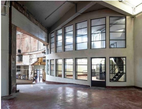
**Bild 7** – Für die grosse Innenverglasung verwendeten die Architekten Jansen Art'15. Die aufs Äusserste reduzierte Ansichtsbreite des neuen, nicht isolierten Stahlprofilsystems von Jansen ermöglicht ein einzigartiges Design und erfüllt die hohen Ansprüche denkmalgeschützter Bauten der Moderne. (jansen.com)
