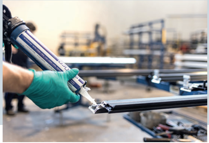
Vorbereitung für die Verklebung des Blendrahmens mit dem speziellen Gehrungsklebstoff. Préparation au collage du cadre dormant avec la colle spéciale pour onglets.
