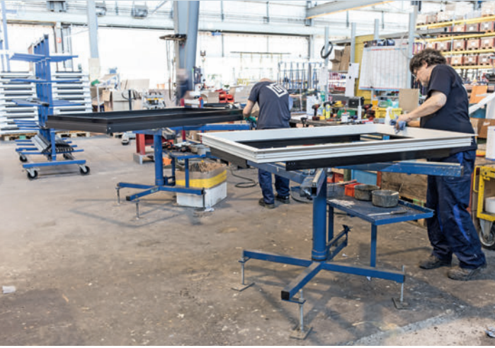
Vorbereitungsarbeiten: links ein Blendrahmen, rechts ein Flügel. Travaux préparatoires: à gauche un cadre dormant, à droite un vantail.
