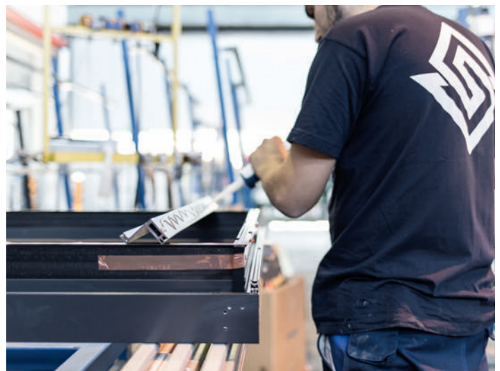
Ein Adapterprofil des kompletten Baukörperanschlussystems für Fensterband und Lochfenster mit optimaler Wärmedämmung und Entwässerung, wird für die Verklebung (Dampfdichtheit) und mechanische Sicherung, vorbereitet. Un profilé d'adaptation du système complet de raccordement au corps de construction pour bandeau de fenêtre et fenêtres fixes avec isolation thermique optimale et drainage, est préparé pour le collage (étanchéité à la vapeur) et la fixation mécanique.
