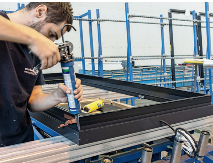
Die Verklebung des Blendrahmens im Eckbereich, in Kombination mit der mechanischen Verbindung, lässt sich einfach und unkompliziert realisieren. Le collage du cadre dormant dans les angles, combiné à un assemblage mécanique, est simple à réaliser.
